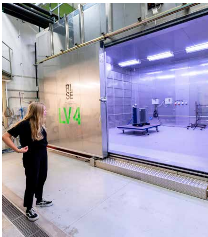
Klimatkammare och testanläggning i Borås för att testa bland annat luftvärmepumpar. Foto RISE
